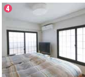
4 寝室：奥行きを広げた寝室に2台のベッドを並べています。2面の大きな窓には断熱内窓を設置し、壁にも断熱材を入れたことで、「暖かい上、静かになった」とのこと。
